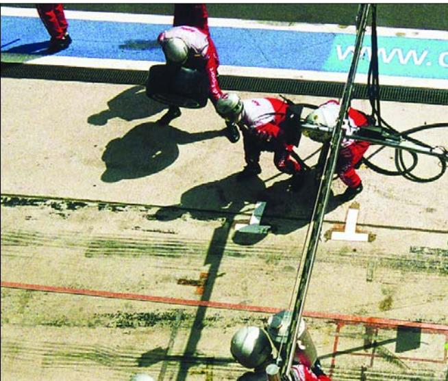
Das gab es schon unzählige Male im Fernsehen zu sehen: Die Boxencrew wartet auf das Rennfahrzeug, um es mit vier frischen Reifen zu versiehen und gleichzeitig zu betanken. Die verkleideten Gasflaschen im Vordergrund enthalten Druckluft für das Anheben des Fahrzeugs und das Betätigen der Schlagschrauber.
