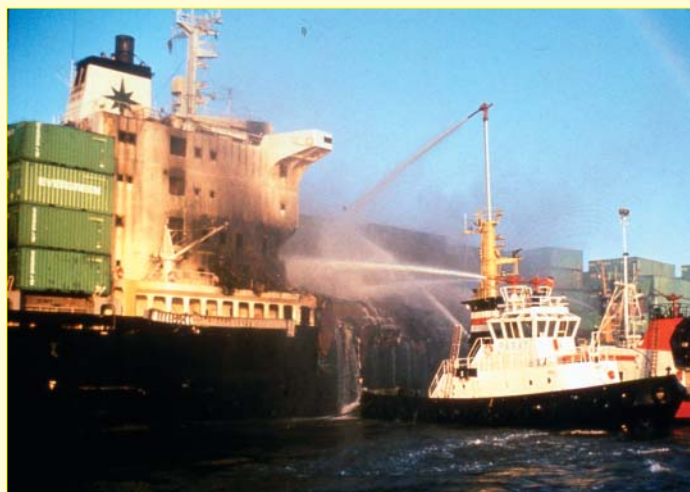
Container und Schiffsbrücke der Ever Level gerieten sofort in Brand. Gelöscht wurde unter anderem mit speziell ausgerüsteten Bugsierschleppern. Zu erkennen sind die Schleifspuren an der Ever Level .
